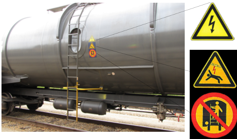
Bild 10: Tankvagn med stege och exempel på varningsskyltning (bild 11, 12)
