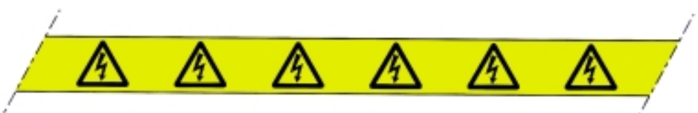
V20 Varningsband anbringas runt stolpe för starkströmsledning. Symbol och bård utförs på gul bakgrund. Bandet utförs ca 100 mm brett.
