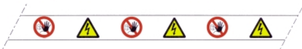
F15 Avspänningsband för tillfällig användning på elarbetsplats där farlig beröring eller åtgärd riskeras. Märkena anbringas på vitt band.
